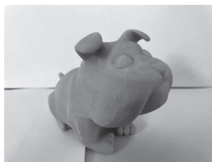
图7 使用 \text{PP}/\text{Eu}(\text{DBM})_3\text{phen} 复合材料进行 3D 打印的模型照片
